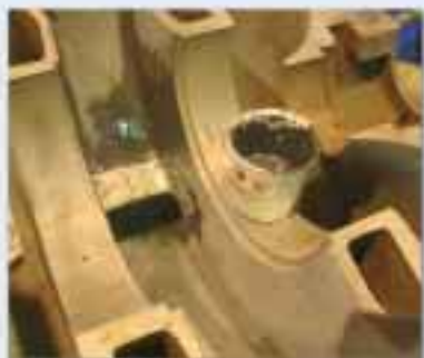
Рис.3: Покрытие насоса Loctite® 7227
