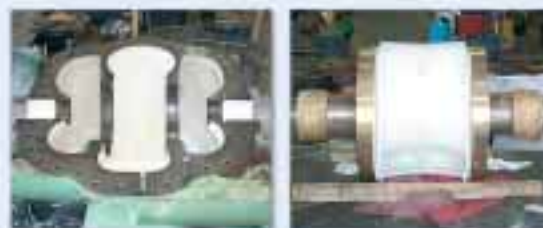
Ремонт поврежденного коррозией вала с помощью Loctite® 3478 Superior Metal. После отверждения можно механически обработать восстанавливаемые поверхности. Окончательно покрываем все рабочие поверхности составом Loctite® Nordbak® 7228 Brushable Ceramic White (сертифицированным для использования в контакте с питьевой водой)
